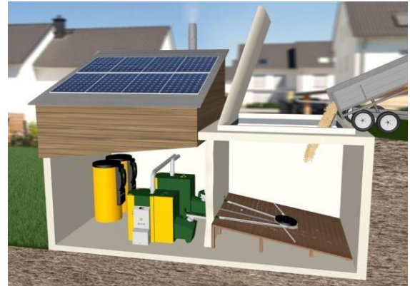
Slika 1: Instalacija kotla na sečku sa skladištem za gorivo, © KWB
